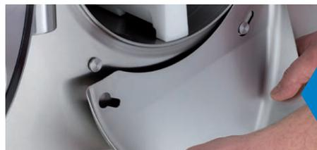
**Lo scivolo di uscita dei prodotti è smontabile**, per facilitare la completa rimozione di ogni residuo di gelato, per una pulizia integrale.
