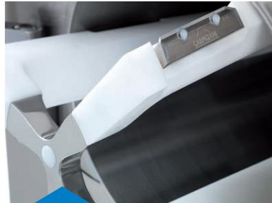
L'agitatore è senza albero centrale e ha le pale in **POM**, impenetrabili al freddo, per la totale espulsione del gelato; rigido e leggero, ha pattini raschianti autoregolanti, per la costante pulizia e resa del cilindro.
