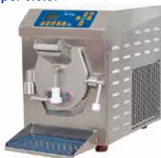
Q3330 Mantecatore elettronico da banco con lavorazione orizzontale - lt.1/3,5 a ciclo
